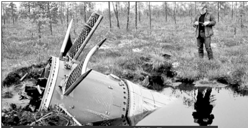
Отработавшая первая ступень МБР "Тополь" после пуска с полигона "Плесецк"
