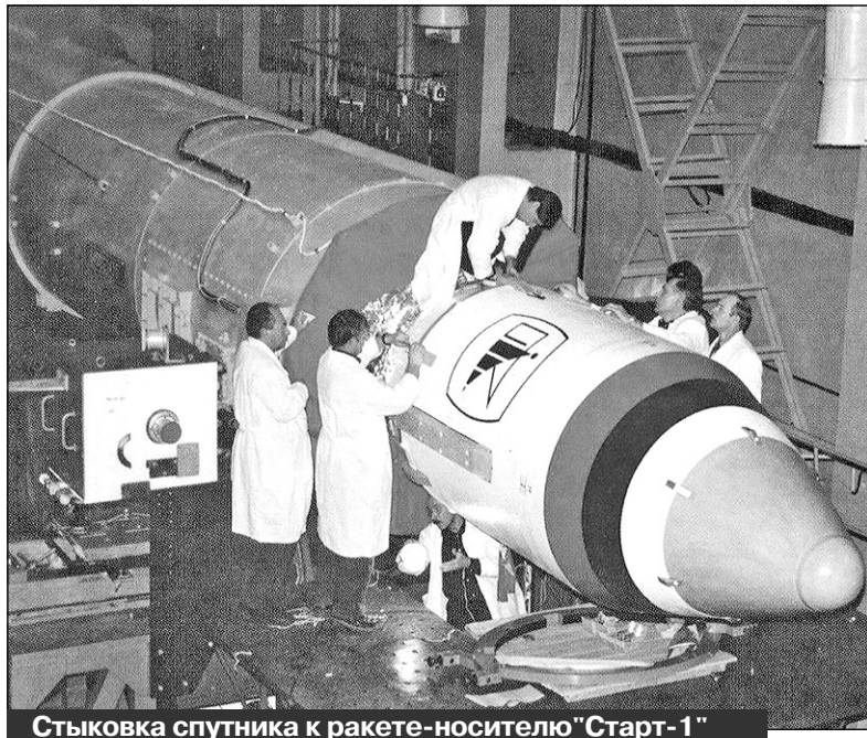
Стыковка спутника к ракете-носителю "Старт-1" в монтажно-испытательном корпусе полигона "Плесецк"
