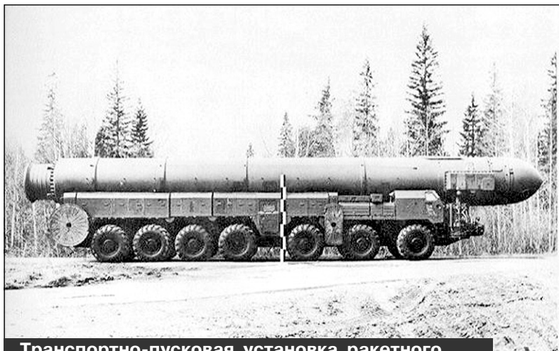
Транспортно-пусковая установка ракетного комплекса "Тополь". Фото 1980-х годов
