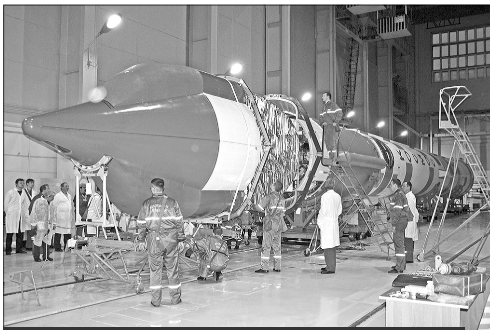
Стыковка головного обтекателя РН "Космос-3М" с КА "SAR-LUPE"
