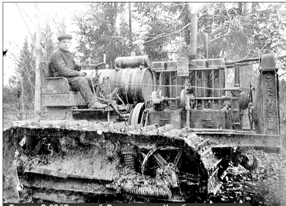
Трактор С-60 "Сталинец". Выпускался на Челябинском тракторном заводе с 1933 по 1937 годы. Широко использовался на лесозаготовках
