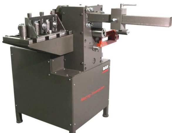
Станок кузнечный для холоднойковки и изготовления фигурных элементов из металла
