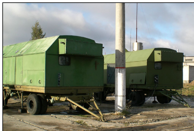
Рисунок 1.17 - Агрегат нейтрализации паров и промстоков горючего 11Г427
