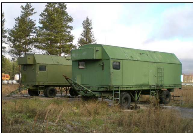
Рисунок 1.16 - Агрегат нейтрализации паров и промстоков окислителя 11Г426
