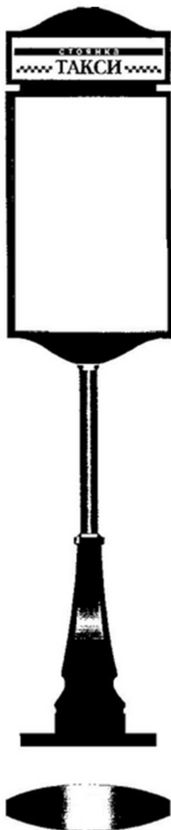
Рис. 3. Указатель остановок городских и маршрутных такси, представляющий собой городской информационный указатель, в верхней части которого располагается световой короб с буквой "Т", со световым панно с размером каждой информационной плоскости 0,8x1,2 м
